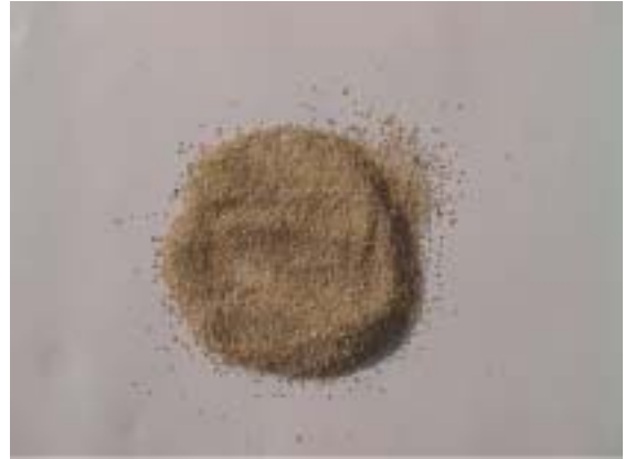
I.-No. 8650 Quartz sand, dry graining 0,3 - 0,8 mm
