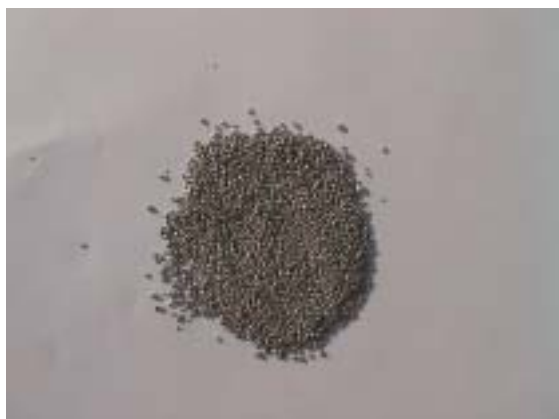
I.-No. 8525 Aluminium granule, round graining 0,5 – 2,5 mm
